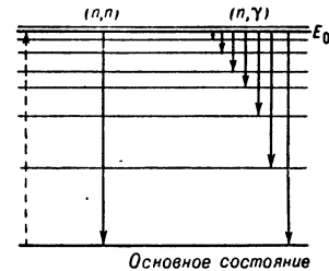
Рис. 2. Схема энергетич. переходов возбужденного промежуточного ядра.
