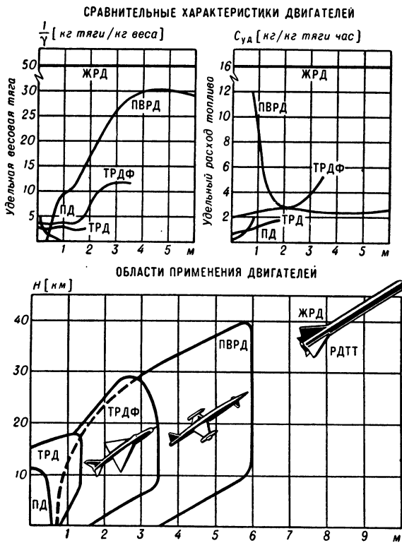
Рис. 8. Сравнительные характеристики и области применения нек-рых типов реактивных двигателей.
