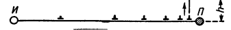
Рис. 3. Схема механизма ползучести, лимитируемой скоростью разрядки дислокационных скоплений путем переползания по Уиртману (Weertman J.).
