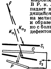
Рис. 13. Схема рентгенодифракционного микроскопа по Лангу: F — тонкий источник рентгеновских лучей; K_{\alpha_1} и K_{\alpha_2} — разделение луча по длинам волн; S_1 — щель коллиматора; O — образец; P — фотопленка; S_2 — ширма, выделяющая одно брэгговское отражение.
