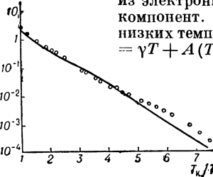
Рис. 8. Зависимость электронной теплоемкости сверхпроводника от темп-ры. Сплошная кривая — теоретическая, экспериментальные точки — для Sn.
